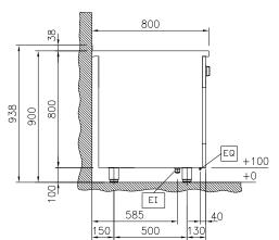
Electrical inlet (power) ΕI EQ Equipolential screw
